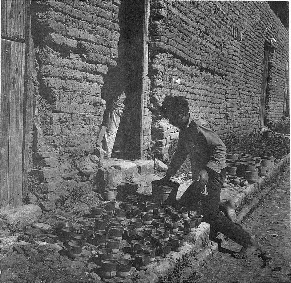
Fig. 12. Una vez que han sido cubiertas con el engobe de barro, las piezas se ponen en la banqueta para que el sol las seque antes de cocerse en el horno del alfarero.
